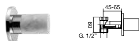
46 016 ●●● Llave de paso empotrar 1/2" Built-in key step 1/2" Robinet d'arrêt de 1/2" Unterputz-ventil 1/2" Кран встроенный 1/2"
